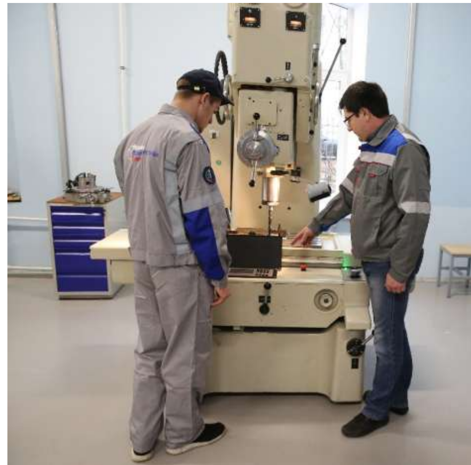
Координатно-расточный станок 2Е440АФ10 (Россия)
