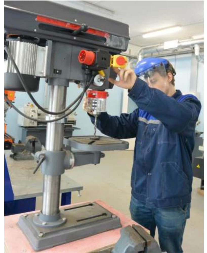
Настольно-сверлильный станок 2М112 (Россия)
