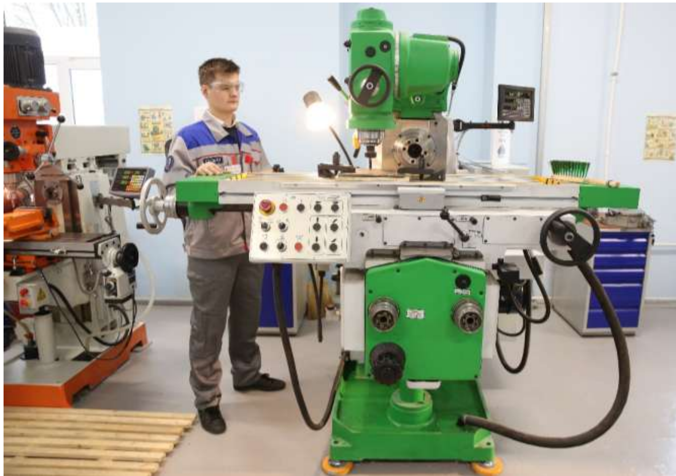
Универсально-фрезерный станок 6Л82Ш (Россия)
